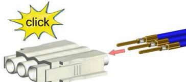
Kontaktstift (2) vollständig ins Gehäuse (3) schieben bis er einrastet.
