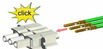
Kontaktbuchse (2) vollständig ins Gehäuse (3) schieben bis sie einrastet.
